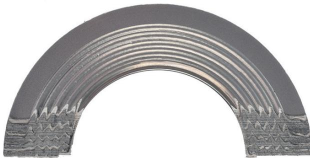
Foto: Schleifbild einer Egraflex Steelflon Waveline WLP® Dichtung
