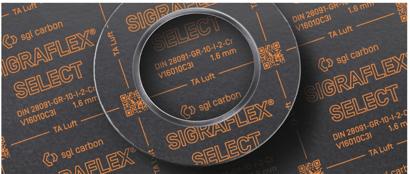
SIGRAFLEX SELECT ist eine Graphitflachdichtung mit Edelstahlinnenbördel aus unterschiedlich dicken Graphitfolien und 0,05 mm dicken Edelstahlfolien. Der gesamte Verbund ist kleberfrei ausgeführt und zur besseren Handhabung und zur Reduzierung der Leckage mit einer Imprägnierung versehen.
