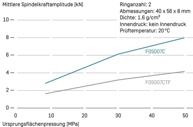
↑ Einfluss der PTFE-Beschichtung der F05007CTF-Folie auf die notwendige mittlere Spindelkraftamplitude bei der Spindelbewegung im 5. Zyklus im eingebauten Zustand von zwei Packungsringen im Vergleich zu Packungen aus F05007C (ohne PTFE).
