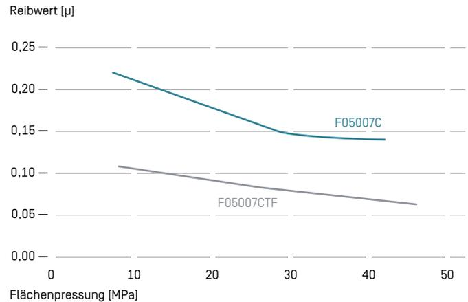
↑ Vergleich der Reibwerte von Stopfbuchspackungen aus F05007C (ohne PTFE) bzw. F05007CTF als Funktion der Flächenpressung.
