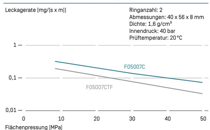
↑ Vergleich der Leckageraten von Stopfbuchspackungen aus F05007C (ohne PTFE-Auflagen) und F05007CTF bei 40 bar Stickstoff-Innendruck und verschiedenen Flächenpressungsstufen.
