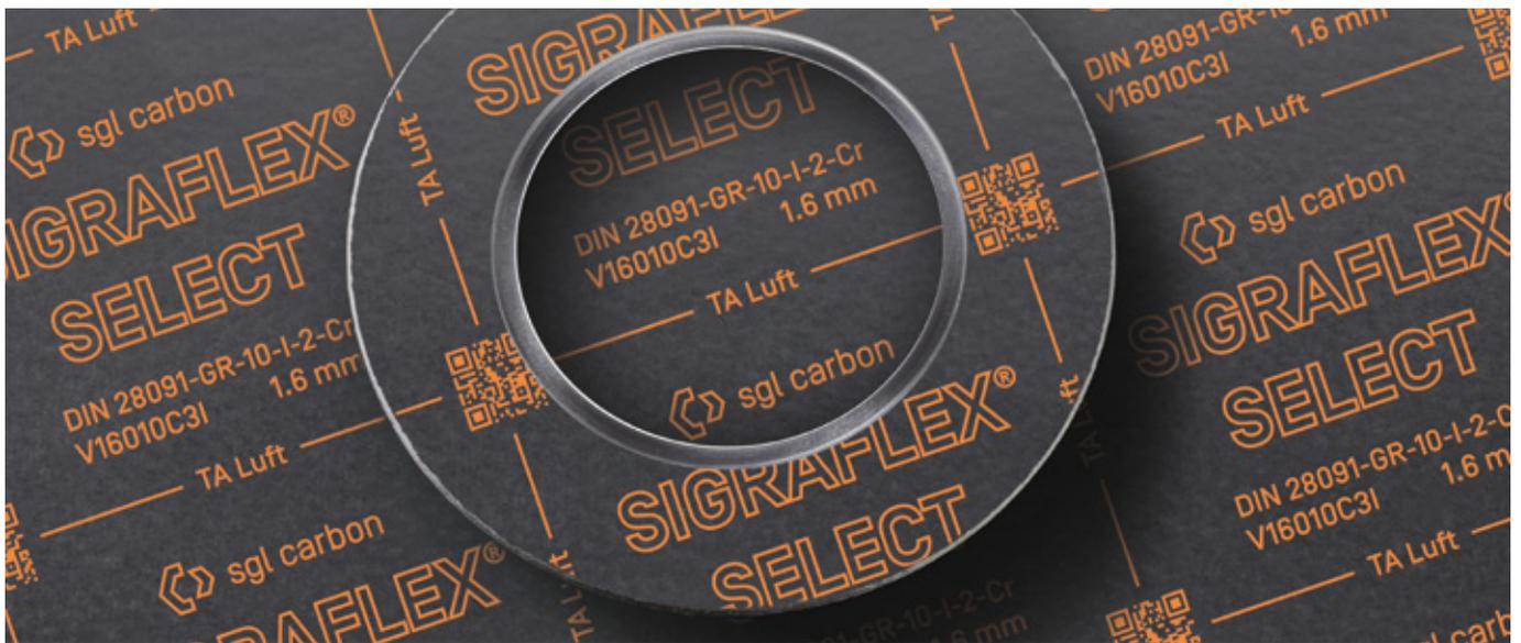
SIGRAFLEX SELECT ist eine Graphitflachdichtung mit Edelstahlinnenbördel. Das Material besteht aus drei unterschiedlich dicken SIGRAFLEX Graphitfolien und zwei 0,05 mm dicken Edelstahlfolien, die mit der bewährten SIGRAFLEX HOCHDRUCK Technologie miteinander verbunden sind. Zur besseren Handhabung und zur Reduzierung der Leckage ist die Dichtungsplatte mit einer Antihaft-Imprägnierung versehen.
